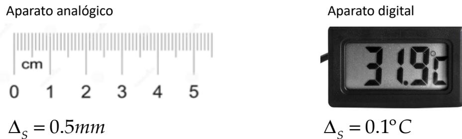
Fig. 1. Ejemplos de instrumentos analógicos y digitales y su asignación del error de sensibilidad.
